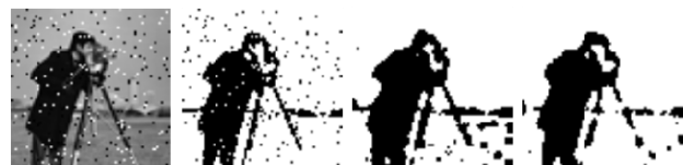
Figure 10. (a) original; (b) FCM; (c) BCFCM_S1 ( \alpha=2 ); (d) ISGEFCM ( m=2, \gamma=10000, \alpha=5, \delta=-5 )
